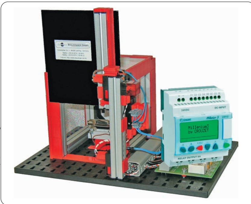
Bild 4: Mit den Regelungsmodellen von Staudinger kann man viele Regler-Varianten erlernen; Grafcet lässt sich für die verschiedenen Aufgaben (Visualisierung, Zeitplanregelung usw.) verwenden
